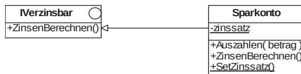
Abbildung 7.13: Schnittstelle – IVerzinsbar mit Implementierung
