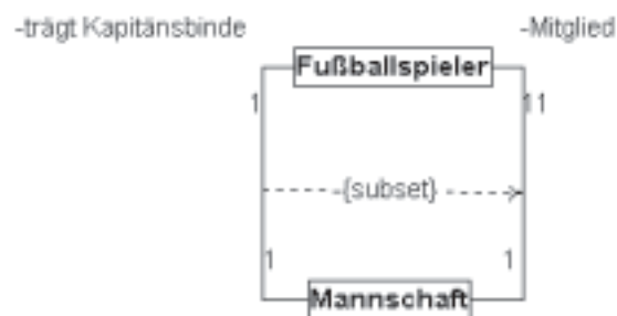
Abbildung E.12: Zusicherung subset
