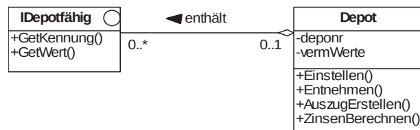
Abbildung 7.15: Schnittstellen – IDepotfähig als Typ von Depot-elementen
