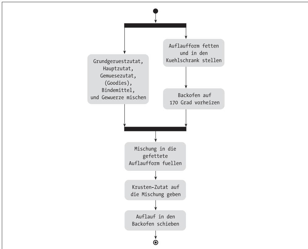
Abbildung 7-3: Das Activity-Diagramm für den Auflauf.
