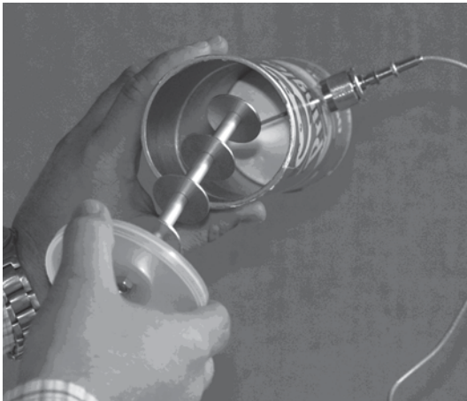
Abb. 10.2 WLAN-Richtfunkantenne aus einer Chipsdose
