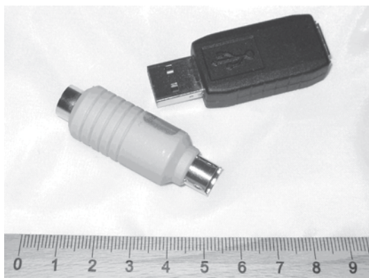
Abb. 4.3 Ein USB- und ein PS/2-KeyKatcher mit WLAN
